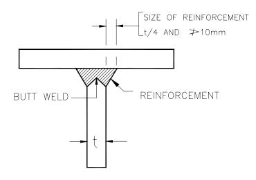
BUTT WELDED T JOINT
